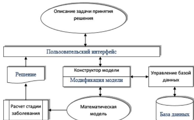
Рис. 2. Общая архитектура системы поддержки принятия врачебных решений. / Fig. 2. The overall architecture of the system support decision-making medical.
