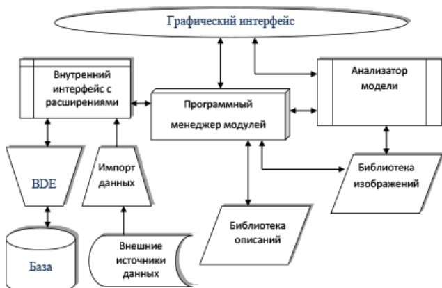
Рис. 1. Структура программного комплекса статистического моделирования. / Fig. 1. Structure of the program complex statistical modeling.
