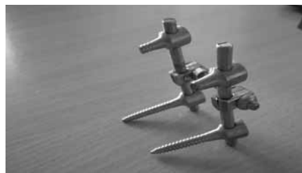
Рис. 1. Общий вид удаленной конструкции с дефектами резьбовых стержней.
