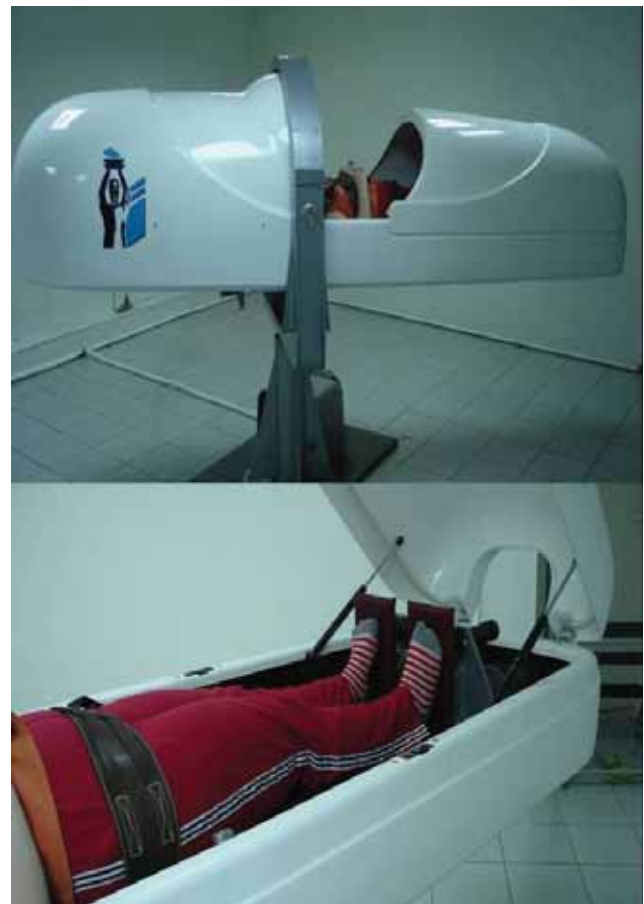
Рис. 1. Стенд искусственной силы тяжести «Салют» (центрифуга короткого радиуса действия).
