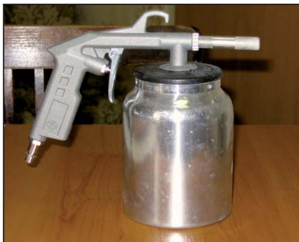
Рис. 2. Общий вид пневмоинсуффлятора.
