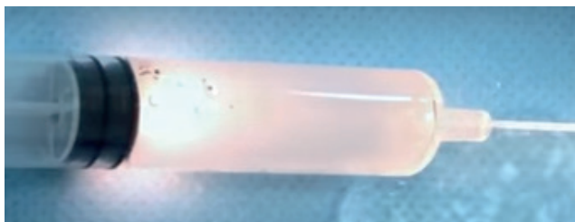
Рис. 3. Случайный контакт работающего конца с уплотнителем поршня. Видна яркая вспышка. / Pic. 3. Accidental contact of the working end with the piston seal. A bright flash is visible.
